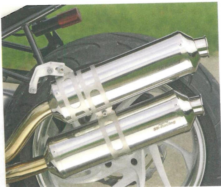
**Bislang noch ein Prototyp: Doppelrohr-Auspuff von SR-Racing**
